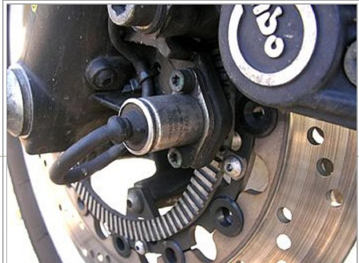
Sensore di velocità angolare montato su una BMW K 1100 LT SE
